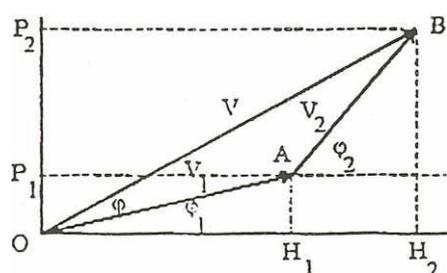
La figure ci-contre montre l'addition des tensions  $v_1$  et  $v_2$  traitée comme une somme de vecteurs :  $v_1$  est représentée par  $\vec{OA}$  et  $v_2$  par  $\vec{AB}$ . Si on appelle  $V$  la longueur de  $\vec{OB} = \vec{OA} + \vec{AB}$ , et  $\varphi$  l'angle que fait  $\vec{OB}$  avec l'axe  $Ox$ , on voit facilement que les projections  $OH_2$  et  $OP_2$  de  $\vec{OB}$  sur  $Ox$  et  $Oy$  s'écrivent:
