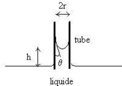
Pour vérifier que  $h$  varie bien comme l'inverse de  $r$ , on va mesurer la hauteur d'ascension dans des tubes capillaires de plusieurs rayons, puis tracer la courbe  $h = f(1/r)$  afin de vérifier qu'il s'agit bien d'une droite passant par l'origine. D'après la loi de Jurin, la pente de cette droite vaut :
