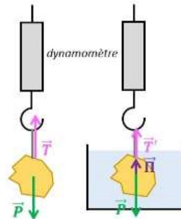
Lorsque l'objet est dans l'air, la force  $T$  que le crochet exerce sur l'objet compense exactement son poids  $P = -\rho Vg$  où  $\rho$  est la masse volumique de l'objet et  $V$  son volume,  $g = 9,81 \text{ m.s}^{-2}$  est l'accélération de la pesanteur et on prend un axe ( $Oz$ ) dirigé vers le haut. On a donc  $T = \rho Vg$
