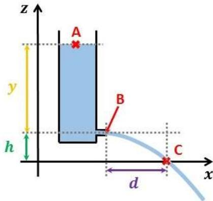
On veut utiliser le théorème de Bernoulli (voir chapitre 2 du cours). Pour cela, on place un point A à la surface du liquide et un point B à la sortie du trou. Attention, comme le diamètre du tuyau est petit – ce qui est nécessaire pour que la bouteille ne se vide pas trop vite – la perte de charge  $\Delta P$  due à la viscosité n'est pas négligeable et il faut utiliser la forme généralisée du théorème de Bernoulli (voir chapitre 3 du cours). On a donc :
