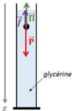
Lorsqu'une bille sphérique de rayon  $R$  se déplace avec une vitesse  $v$  dans un liquide visqueux de viscosité dynamique  $\eta$  et que l'écoulement du liquide autour de la bille est laminaire, alors d'après la **loi de Stokes**, le liquide exerce sur la bille une force de frottement  $f = -6\pi \eta R v$
