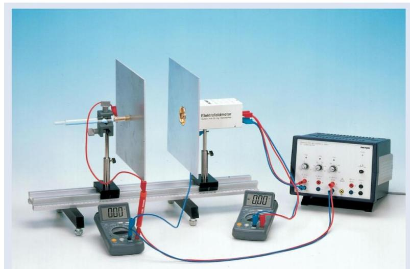
Nous utilisons le premier multimètre pour mesurer la tension sur les plaques de condensateur et le deuxième pour mesurer la valeur de tension qui proportionnelle au champ électrique. Pour avoir la valeur de champ électrique en V/m il faut multiplier la valeur en volt sur le deuxième multimètre par  $100 \text{ m}^{-1}$  pour le calibre 1kV/m, par  $1000 \text{ m}^{-1}$  pour le calibre 10kV/m et par  $10000 \text{ m}^{-1}$  pour le calibre 100 kV/m.
